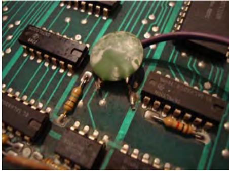
Verbindung zu einem Bauteil durchtrennt war. Als ich die Verbindung wieder herstellte, startete der PET automatisch ins BASIC, ohne dass man den Reset-Taster drücken müsste – genau so, wie es normal sein sollte. Fehler beheben! Nach 20 Jahren...
