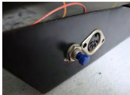
verlötet. Vermutlich diente diese für eine externe Tastatur, die mir aber nicht mitgeliefert worden war, womit die Buchse keine sinnvolle Funktion mehr aufwies. Zusätzlich war am Gerät ein Reset-Schalter angebracht, den ich jedoch nicht entfernte.
