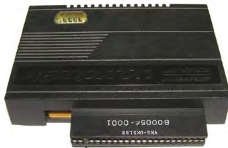
Das Kempston-Interface zum Anschluss eines Joysticks an den ZX Spectrum
