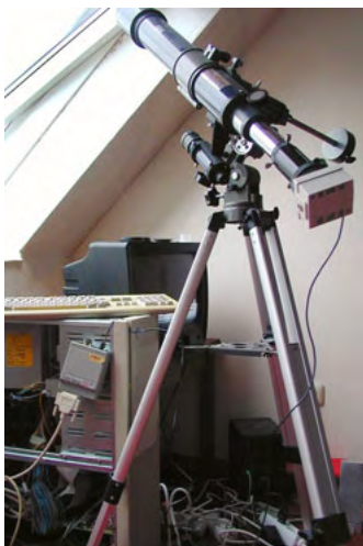
Die Amiga-Astrokamera: Links unten im Bild der Vidi-Amiga-RT-Pro-Digitizer, welcher an die Parallel-Schnittstelle des Amiga 2000 angeschlossen wird. Rechts im Bild das Lidl-Scope mit der CCD-Kamera in einer wetterfesten „Aufputzsteckdose“.
