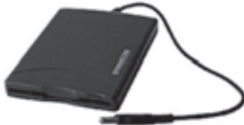
Ein USB-Diskettenlaufwerk. Dank dieses Geräts lassen sich Macs und PCs ohne Diskettenlaufwerk mit einem solchen nachrüsten.
