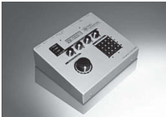
Die SidStation ist ein Synthesizer, der ausschließlich mit SID-Chips auskommt.
